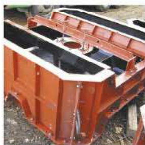
①型枠組立
